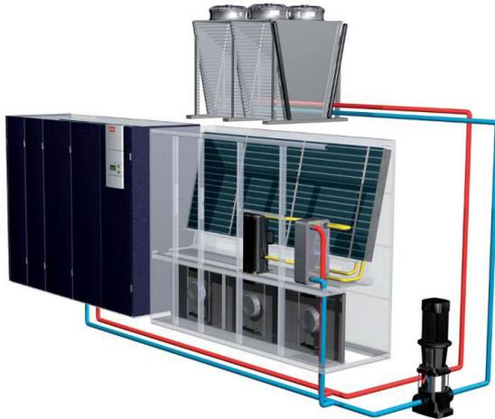
Distancia y/o recorrida de tubería entre la evaporadora y el punto remoto de disipación no favorece el sistema DX tradicional.
