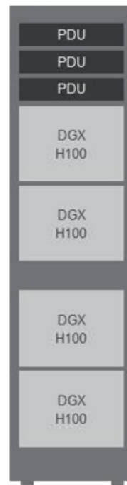
Rack de servidores NVIDIA AI de uso general
